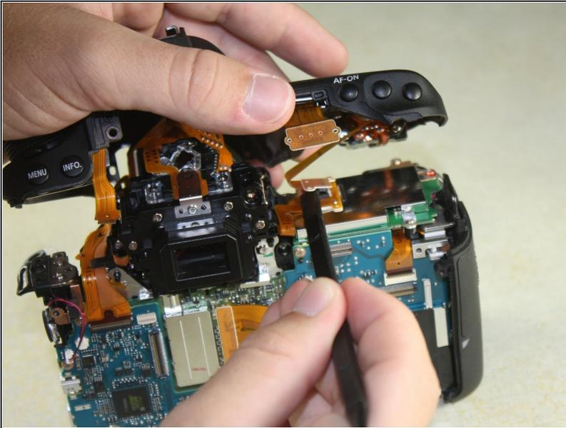
⚠ Eine weiteres Flexkabel verbindet das Innere der Kamera mit der oberen Abdeckung.
