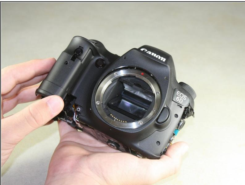
**⚠ Das rote Lautsprecherkabel ist mit der Vorderseite verbunden. Das gewaltsame Öffnen der Vorderseite kann zu Schäden führen.**
