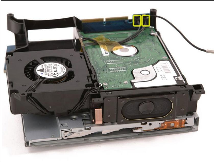
**⚠** Die Kabel, die du jetzt ausbauen wirst, sind sehr empfindlich. Ziehe nicht an den Kabeln, sondern versuche, direkt den Stecker hochzuhebeln. Benutze deinen Fingernagel oder einen kleinen Flachsraubendreher, wenn nötig.
