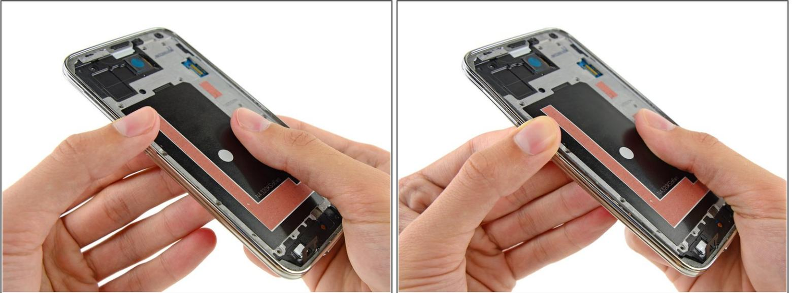
**i** Der Mittelrahmen besteht aus zwei Hälften, die die Hauptplatine umfassen.
