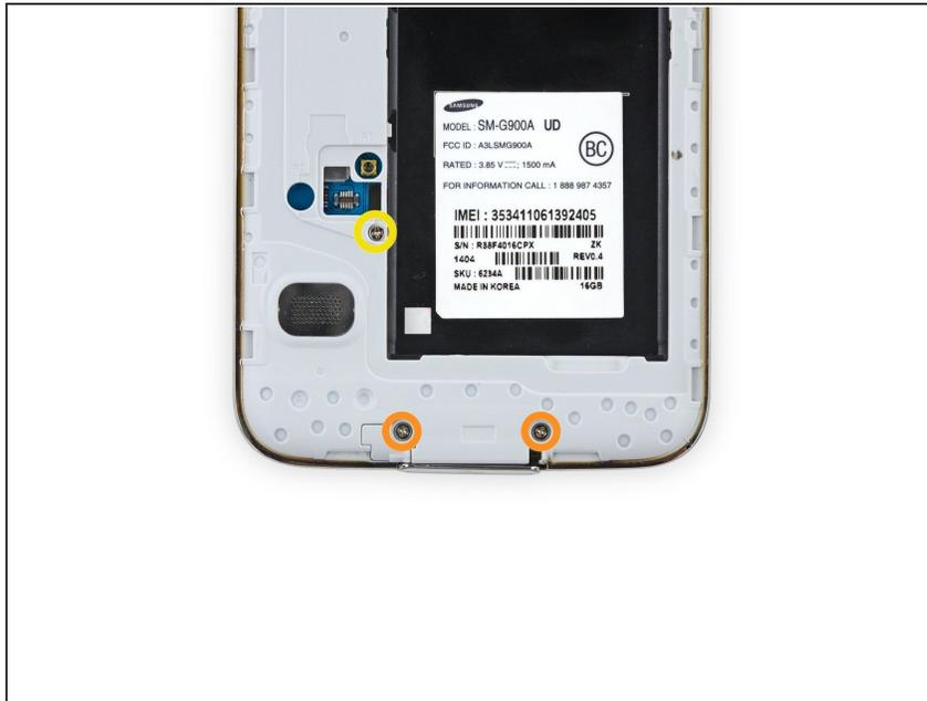
**i** Drehe das Handy um und entferne folgende Schrauben aus der Akkuseite des Mittelrahmens:
