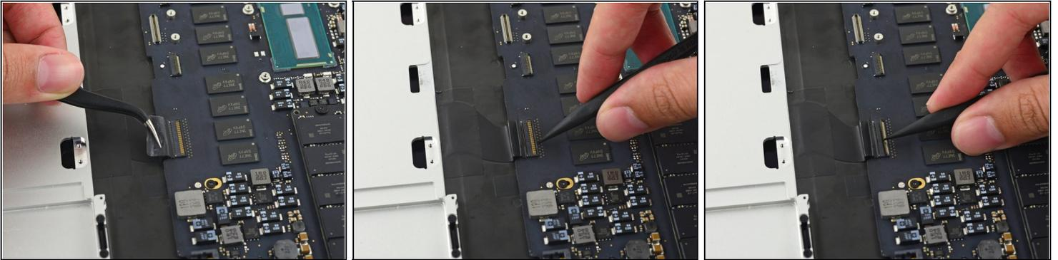
① Löse, falls nötig, das Klebeband ab, welches den Verbinder des Tastaturkabels bedeckt.
