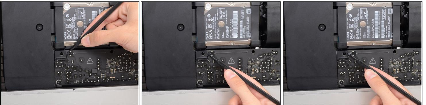
**⚠** Die nächsten Schritte bringen deine Hände in die Nähe der offenen Oberfläche der Netzteilplatine. **Fasse diese und die offenen Lötstellen nicht an**, um einen Stromschlag von den vielen großen Kondensatoren auf der Platine zu vermeiden.
