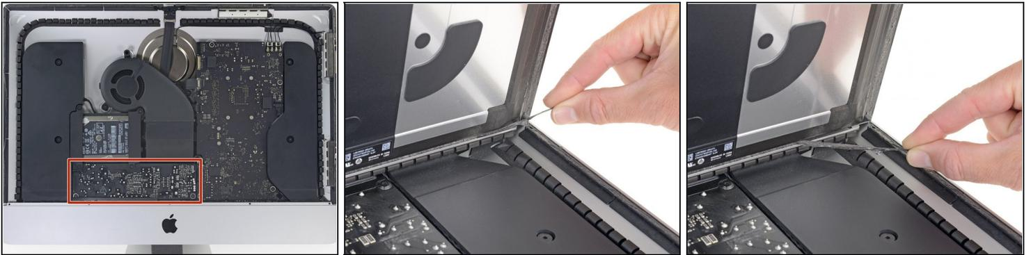
**⚠ Sei vorsichtig und berühre nicht die Anschlüsse der Kondensatoren oder freiliegende Lötstellen auf der Rückseite der Netzteilplatine (rot markiert).**
