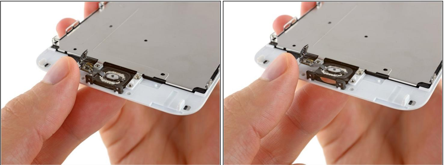
⚠ Die Gummidichtung um den Home Button ist sehr dünn und zerreißt leicht.
