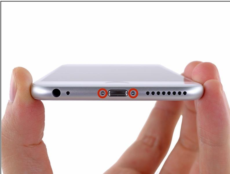
**⚠** Entlade dein iPhone auf unter 25%, bevor du es demontierst. Eine geladene Lithium-Ionen-Batterie kann Feuer fangen und/oder explodieren, wenn man sie aus Versehen ansticht.
