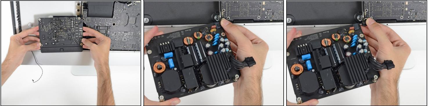
**⚠ Sei ganz vorsichtig** und berühre keine Lötstellen oder Kondensatorkabel auf der Rückseite der Versorgungsplatine. Fasse nur die Kanten an.
