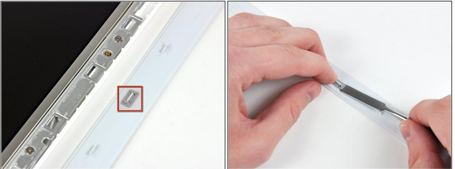
ⓘ Es kann sein, dass manche Clips die eigentlich am LCD-Panel befestigt bleiben sollten, an der vorderen Displayabdeckung hängen bleiben. Die folgenden Schritte erklären, wie man diese Clips wieder an das LCD-Panel anbringen kann.
