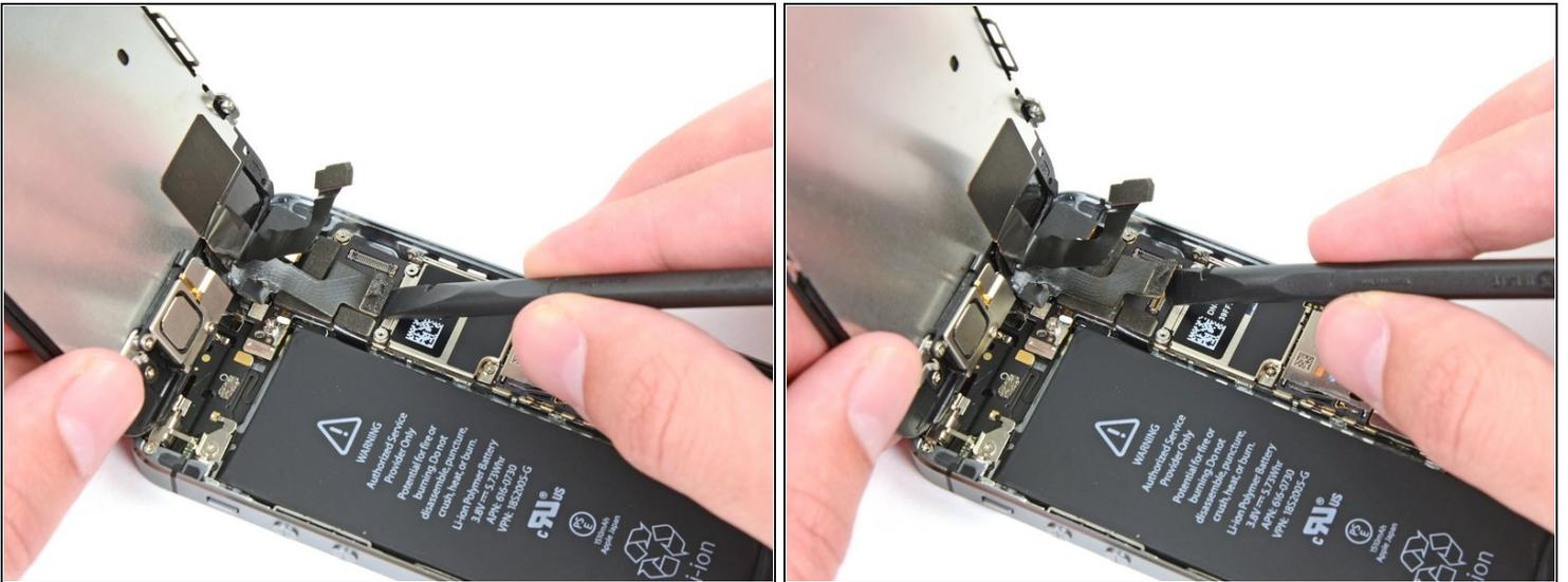
**⚠ Achte darauf, dass der Akku abgetrennt ist, bevor du das Kabel in diesem Schritt abtrennst oder wieder verbindest.**
