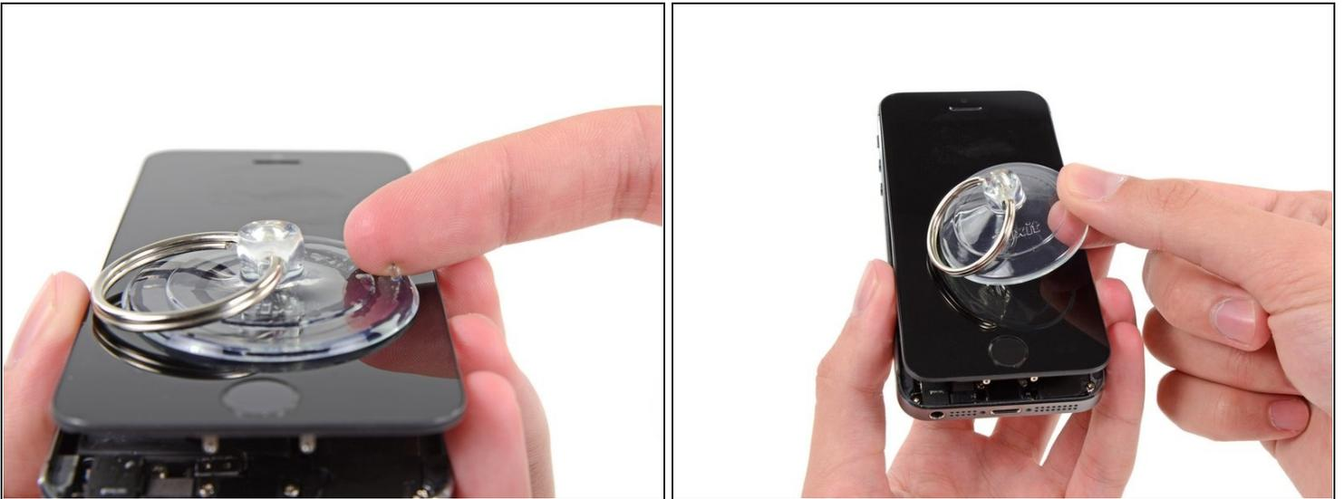
**⚠** Versuche nicht, die Display Einheit vollständig vom hinteren Gehäuse zu lösen, da beide immer noch durch mehrere Flachbandkabel verbunden sind.
