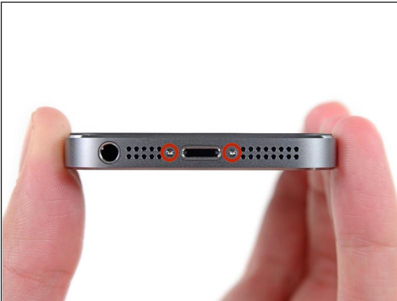
**⚠** Entlade den Akku deines iPhones auf unter 25%, bevor du weitermachst. Eine geladene Lithium-Ionen Batterie kann Feuer fangen und/oder explodieren, falls sie beschädigt wird.
