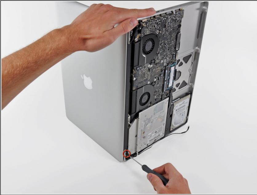
**⚠** Achte darauf, das Display und das obere Gehäuse weiterhin mit der Hand zusammenzuhalten. Wenn du das nicht tust, kann das Display/obere Gehäuseteil herunterfallen und unter Umständen kann jede Komponente beschädigt werden.
