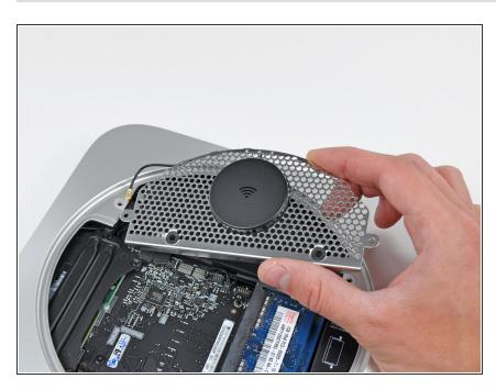
Entferne die Antennenplatte vom Mini.
