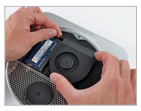
Hebe die Ausbuchtung am Lüfter, der dem RAM am nächsten ist, aus dem Abstandshalter am hinteren Gehäuse.
