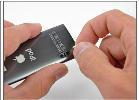
ⓘ Zwischen Kamera und Mikrofon befindet sich ein kleiner weißer Halter, der innere Bauteile vor Bewegung sichert.
