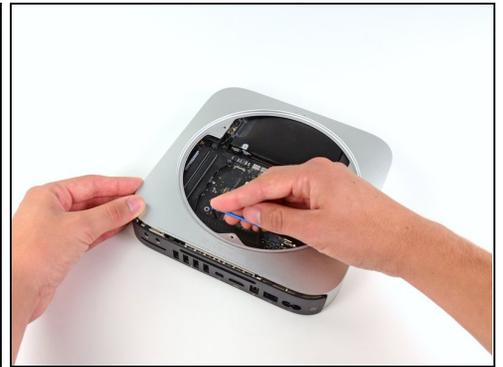
**⚠** Zum Entfernen des Logic Boards müssen die beiden zylinderförmigen Stäbe des [Mac Mini Logic Board Removal Tools](#) in die mit Rot gekennzeichneten Löcher gesteckt werden. Die Platine kann zerstört werden, wenn Instrumente in irgendwelche anderen Löcher der Platine gesteckt werden (außer den Markierten).
