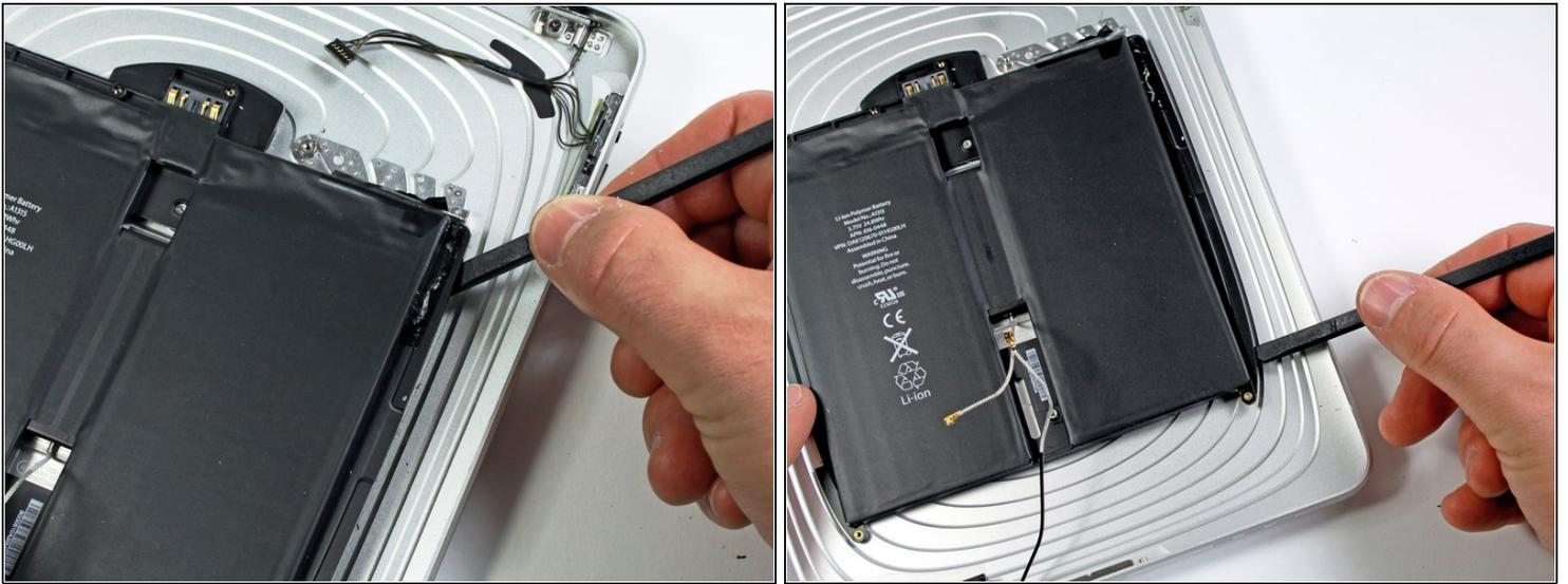
**⚠ Der Akku ist durch eine übermäßige Menge an Klebstoff am Rückgehäuse befestigt. Gehe mit Geduld und Vorsicht vor.**
