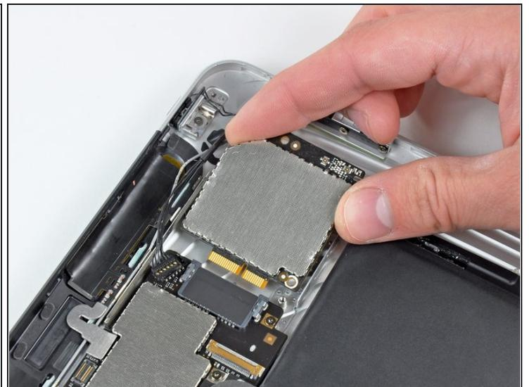
ⓘ Hebe bei Bedarf die rechte Kante der Kommunikationsplatine nach oben, um sie von dem Klebepad am Rückgehäuse zu lösen.
