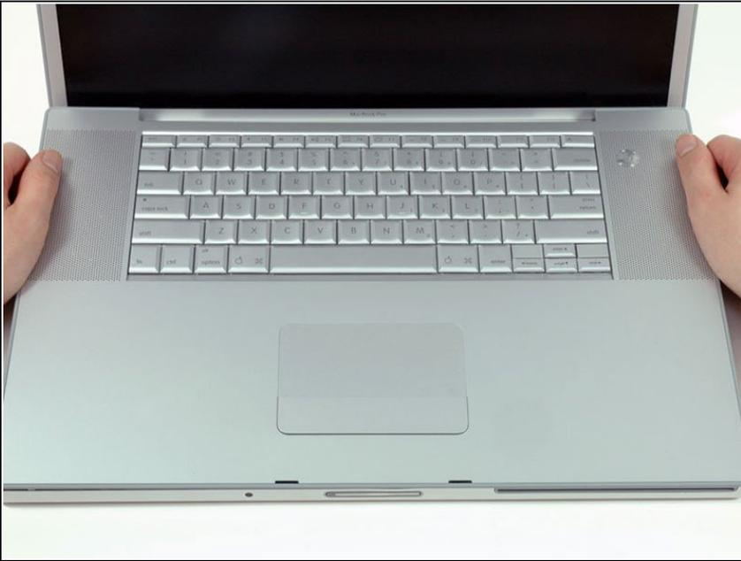
**⚠** Ziehe das obere Gehäuse nicht vorschnell ab. Das Gehäuse ist über ein Flachbandkabel mit dem Logic Board verbunden.
