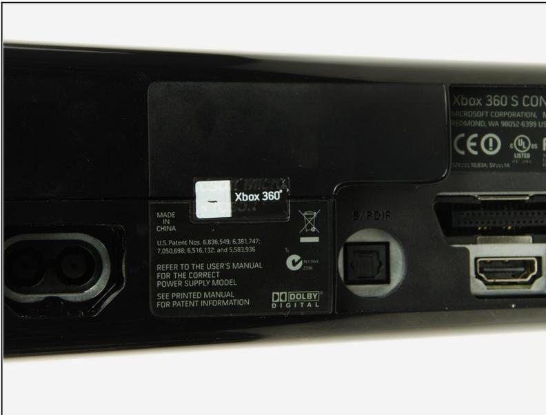
⚠ Wenn du die Xbox 360 S weiter öffnest, musst du die Garantiefleber zerstören oder ablösen. Wahrscheinlich geht dadurch die Garantie für alle Bauteile verloren, die nicht direkt an der Hauptplatine befestigt sind.
