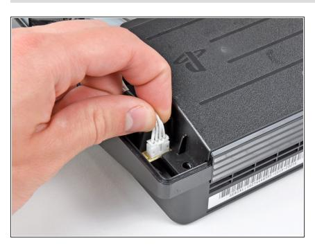
Ziehe den Stecker der Gleichstromversorgung an den Kabeln gerade hoch und aus dem Sockel am Netzteil.
