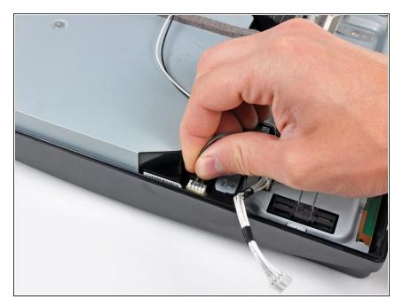
Ziehe das Stromkabel des Blu-ray Laufwerks gerade aus seinem Sockel am Laufwerk.
