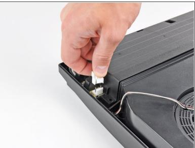
Drücke die Rasten an der Netzeingangsbuchse und ziehe sie gerade vom Netzteil hoch.
