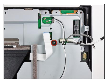
Das Blu-ray Laufwerk ist mit einer 9,5 mm Kreuzschlitzschraube am Gehäuse befestigt. Drehe sie heraus.
