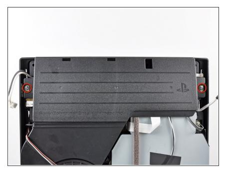
Das Netzteil ist mit zwei 7,6 mm Kreuzschlitzschrauben am unteren Gehäuse befestigt. Drehe sie heraus.
