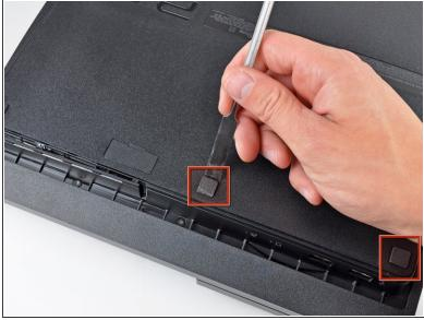
Benutze die flache Seite eines Metallspatels, um die sieben Schraubenkappen an den Kanten des unteren Gehäuses herauszuhebeln.
