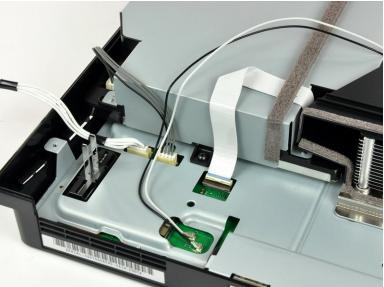
Wenn vorhanden, musst du die Klebestreifen, welche die Kabel auf dem Laufwerk festhalten, abziehen.
