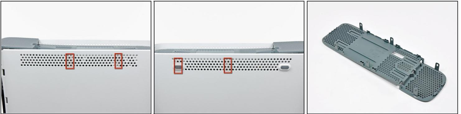
ⓘ In den nächsten Schritten, verwende die Spitze eines Spudgers oder den Stift eines Xbox 360 opening tools, um die Klammern an der Oberseite der Seitenabdeckungen zu lösen.
