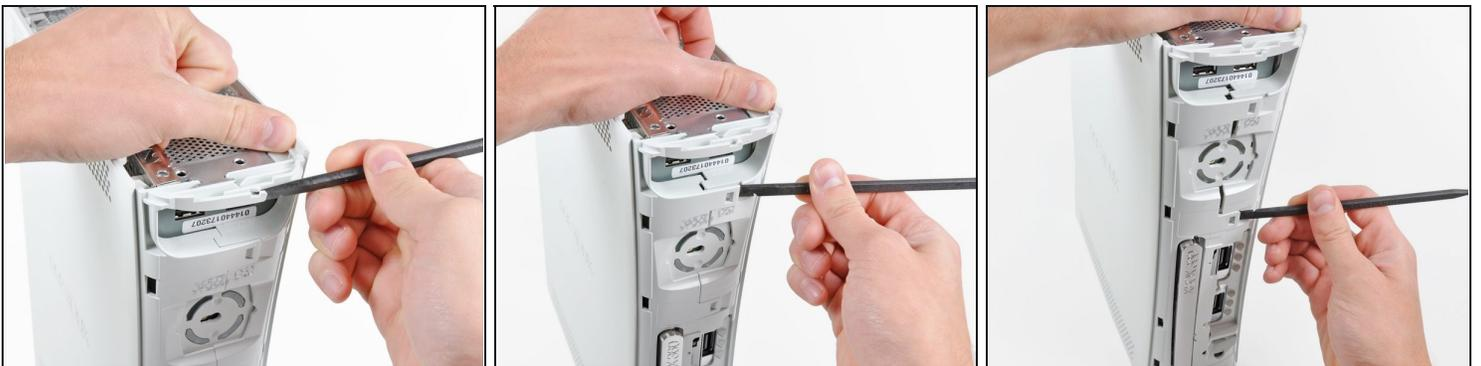
ⓘ Die obere und untere Abdeckung der Konsole sind mit mehreren Verriegelungen befestigt. Diese Verriegelungen müssen gelöst werden um die obere und untere Abdeckung von der Konsole zu nehmen.
