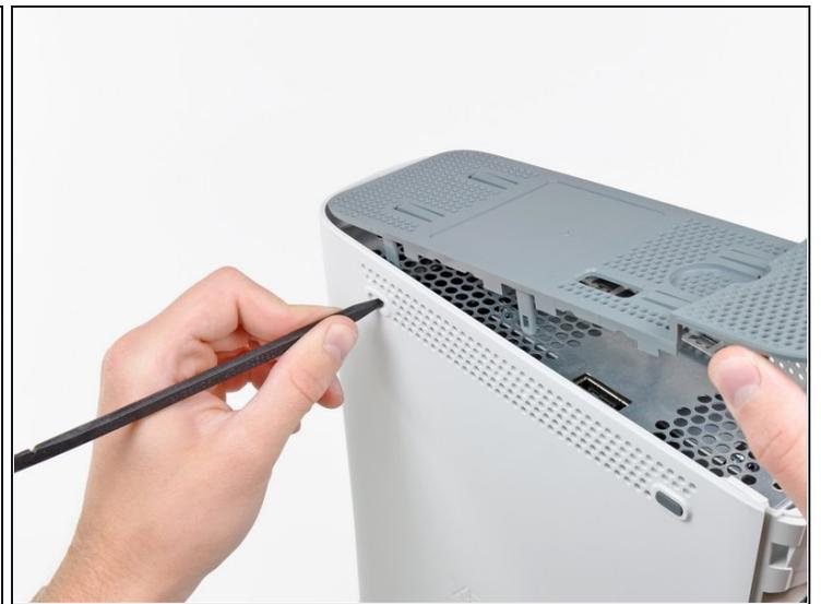
ⓘ Die letzte Klammer ist unter dem Gummifuß am hinteren Teil der Konsole versteckt.
