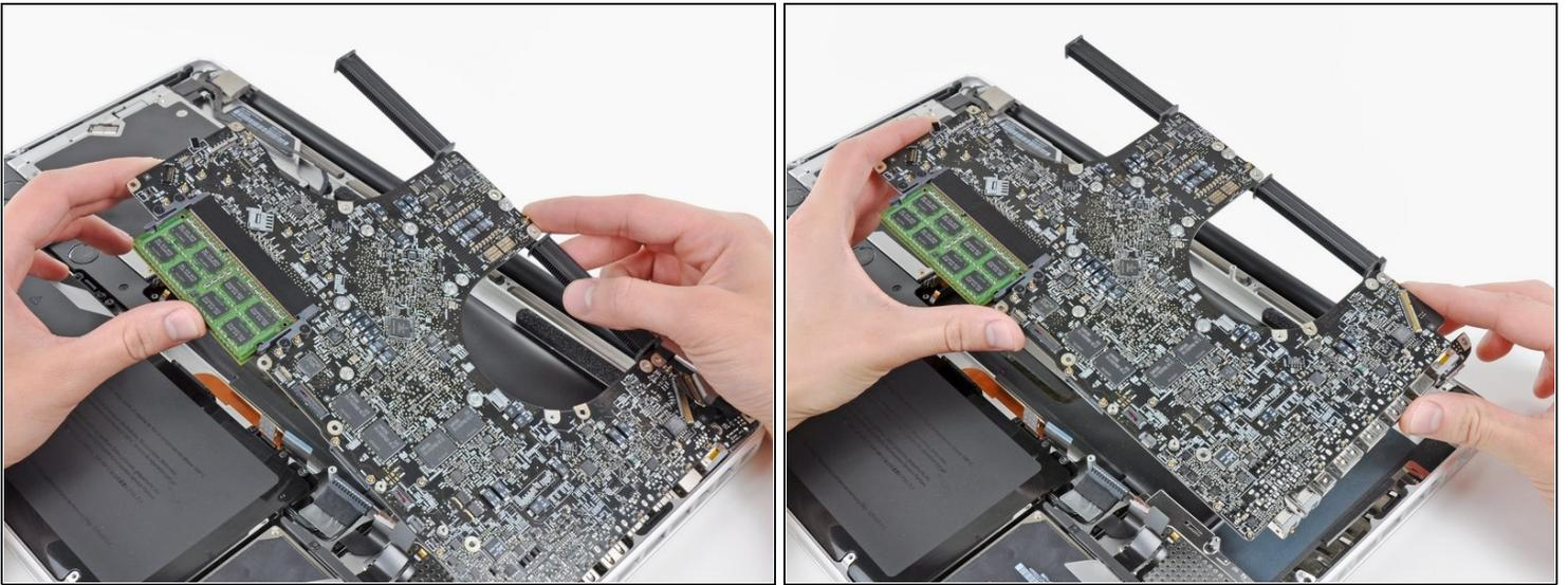
**⚠ Fasse die Logic Board-Einheit nur an den Kanten an.**
