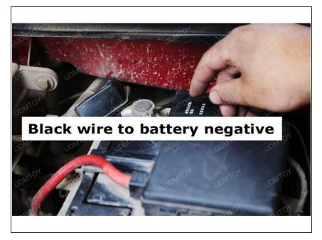
Verbinde das schwarze Kabel mit dem Minuspol der Batterie.
