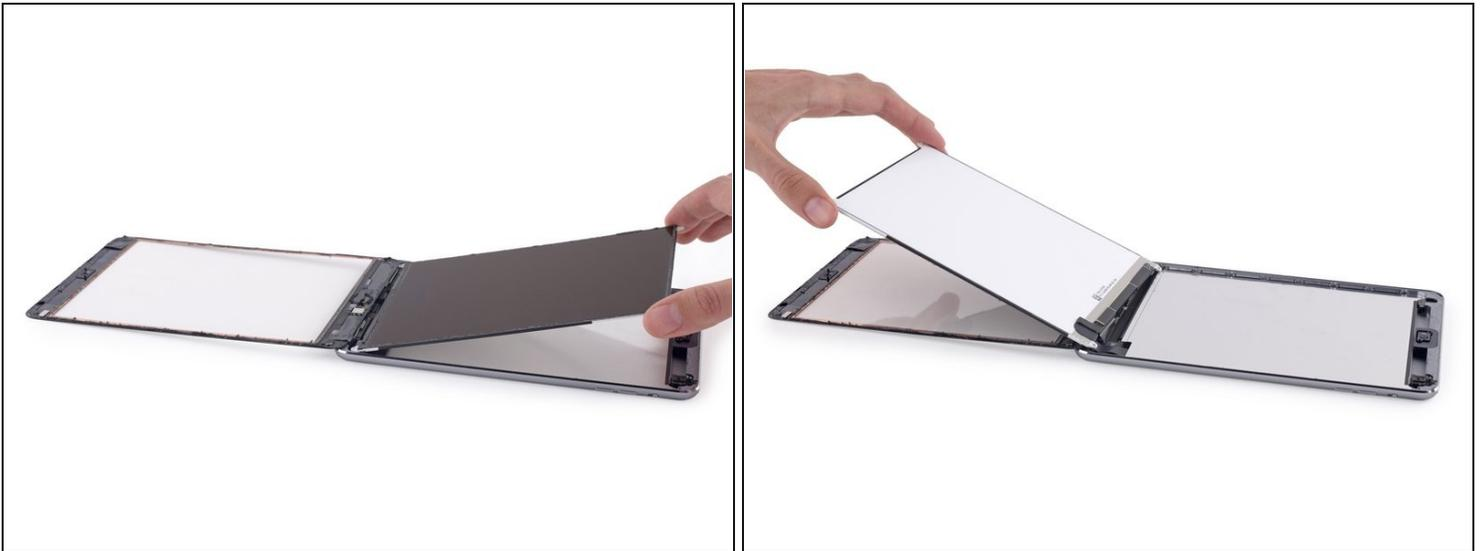
⚠ Versuche nicht das LCD ganz zu entfernen. Es ist immer noch über verschiedene Kabel mit dem iPad am Ende mit dem Home Button verbunden. Hebe nur am Ende mit der Frontkamera an.
