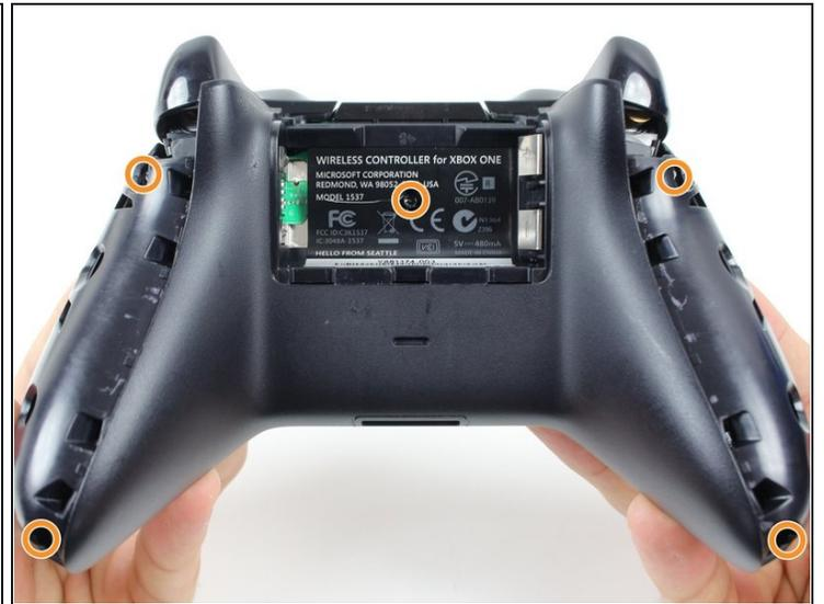
ⓘ Hinter einem Aufkleber in der Mitte des Controllers ist eine Schraube verborgen.
