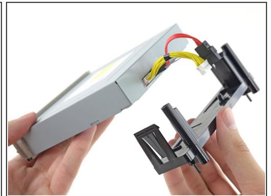
**i** Der Einschub des optischen Laufwerks ist mit zwei Plastikclips am optischen Laufwerk festgeklemmt.
