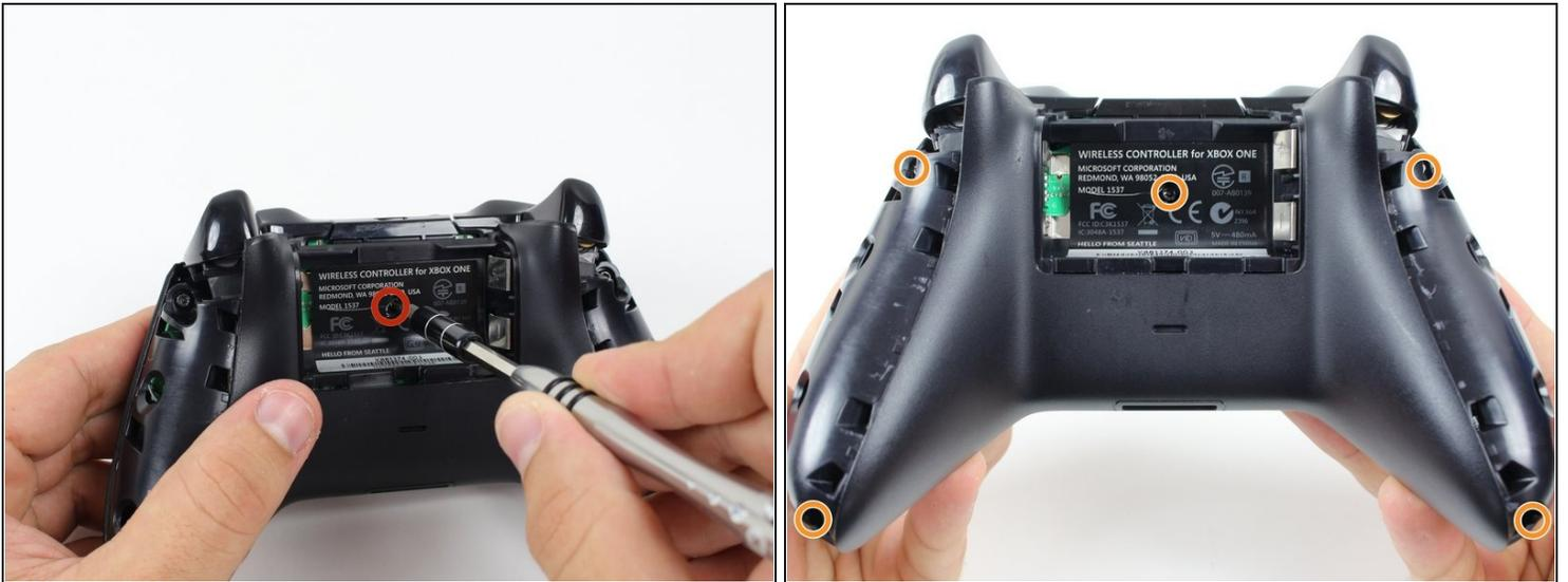
ⓘ Hinter einem Aufkleber in der Mitte des Controllers ist eine Schraube verborgen.
