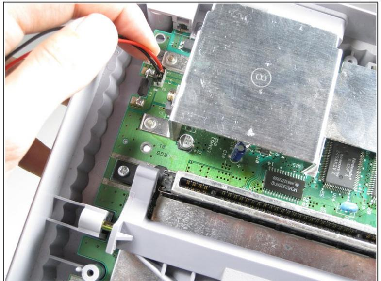
**i** Der Einschaltknopf ist oben links an der Hauptplatine angeschlossen.
