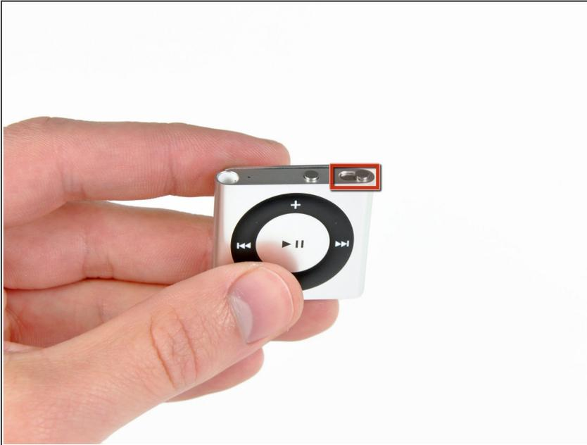
**!** Es ist sehr schwer in das Innere des Shuffles der 4. Generation zu gelangen, weil die Rückabdeckung sowohl mit der Vorderseite verklebt ist als auch mit Metallklammern gehalten wird. Es ist kaum zu erwarten, dass du die Rückabdeckung des Shuffles ohne Schäden öffnen kannst.
