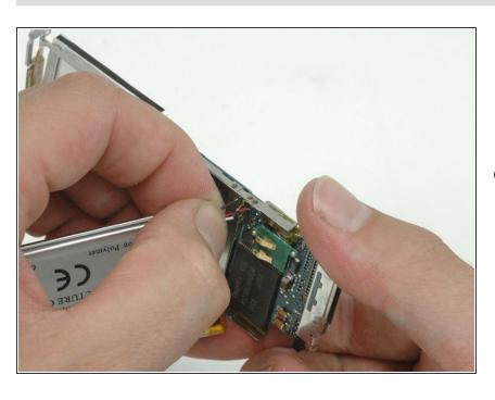
Ziehe die Kabel durch das Logic Board durch, um den Akku abzulösen. Wenn sie nicht leicht
