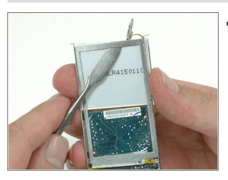
Heble die Metallhalterung vorsichtig mit einem Metal Spudger von der Rückseite des Displays ab. Achte darauf, dass du nur an der Metallhalterung arbeitest und nicht an der durchsichtigen Schutzfolie auf der Rückseite des Displays. Wenn du von innen her am Display arbeitest, dann kannst du die Schutzfolie nicht versehentlich beschädigen.
