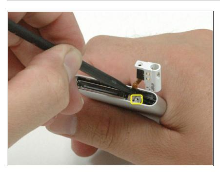
Zum Entfernen des Logic Boards musst du die Spudgerspitze in das Schraubenloch setzen und das Board vorsichtig herausdrücken. Es wird durch die Spalte festgehalten und die Gefahr, dass es beschädigt wird, ist kleiner.
