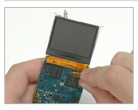
Ziehe das orangefarbene Klebeband vom Flachbandkabel zum Display ab.
