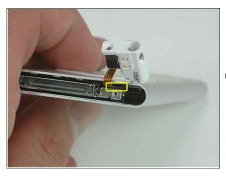
Der markierte Stecker verbindet das Klickrad und die Kopfhörerbuchse mit dem Logic Board. Bevor du
