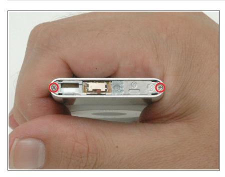
Entferne die beiden Kreuzschlitzschrauben #00 oben am iPod.
