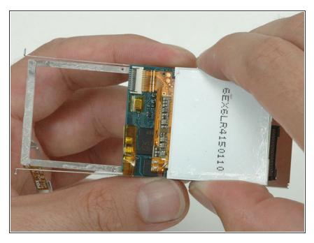
Hole das Display-Flachbandkabel aus seinem Anschluss heraus und hebe das Display vom Logic Board weg.
