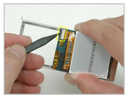
Klappe mit einem Spudger die schwarze Kunststofflasche hoch, die das orangefarbene Flachbandkabel festhält. Die Lasche lässt sich um 90° drehen und gibt dann das Flachbandkabel frei.
