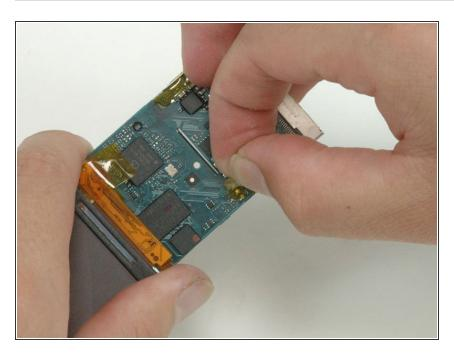
Ziehe das orangefarbene Klebeband von den drei Lötstellen auf der anderen Seite des Logic Boards ab.
