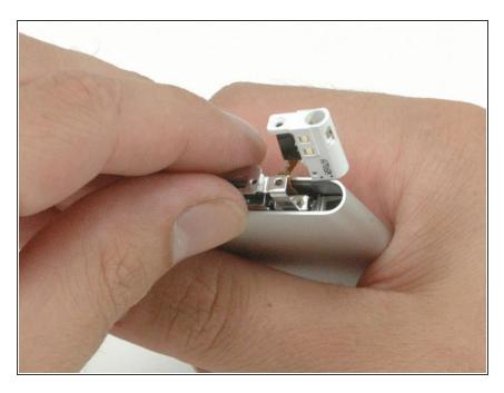
Hebe die Halterung der unteren Blende aus dem iPod heraus.
