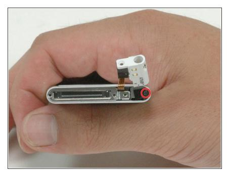
Jetzt ist eine Kreuzschlitzschraube #00 unter der Kopfhörerbuchse freigelegt. Drehe sie heraus. Sei vorsichtig, der Kopf dieser Schraube kann leicht beschädigt werden.
