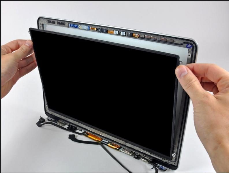
⚠ Versuche noch nicht, das LCD zu entfernen. Die Leitungen entlang der Unterkante sind noch in einem Spalt in der Einlassung für das LCD in der Aluminium-Displayeinheit eingezwängt.
