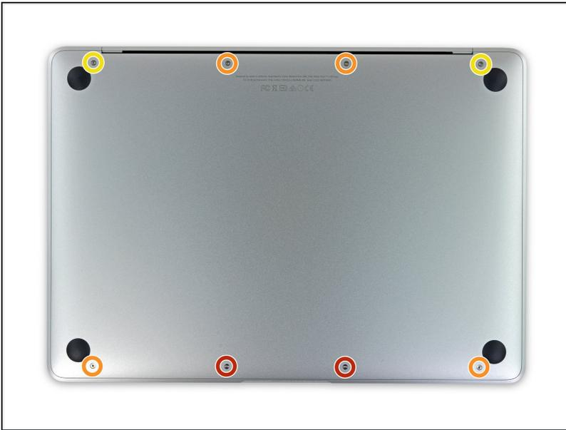
**⚠** Bevor du weiterarbeitest, ziehe das Netzkabel und schalte das MacBook aus. Klappe das Display zu und lege den Laptop mit der Unterseite nach oben.
