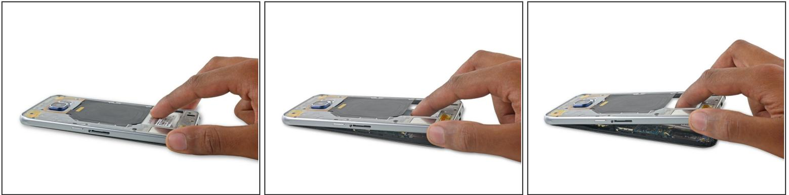
**⚠ Achte unbedingt darauf, dass du den SIM-Kartenschub ausgeworfen hast, bevor du diesen Schritt hier durchführst.**
