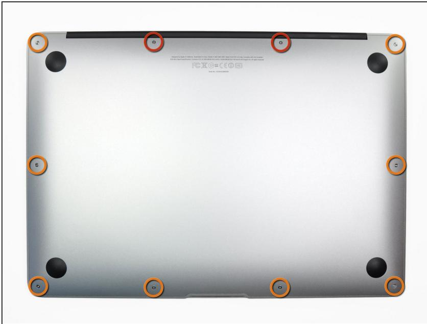
**i** Bevor du weitermachst, schalte das Gerät aus, schließe den Deckel und lege den Computer mit der Unterseite nach oben auf eine weiche ebene Oberfläche.
