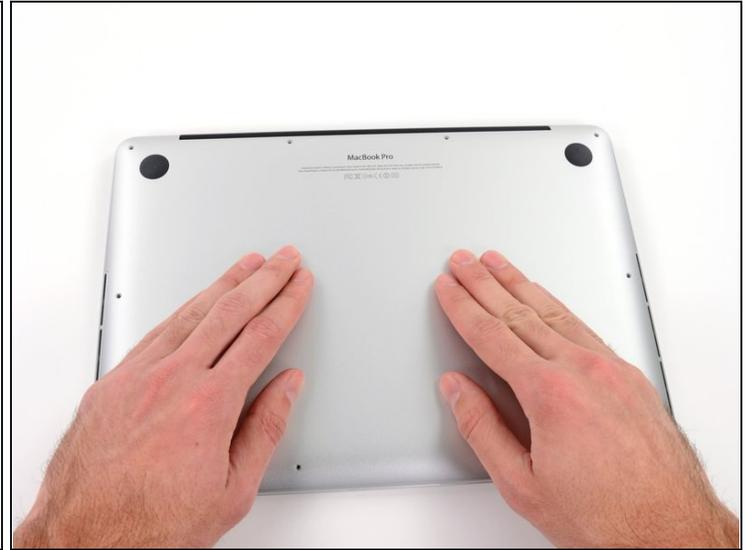
ⓘ Der Gehäuseboden ist durch zwei Steckverbindungen in dessen Mitte mit dem Gerät verbunden.
