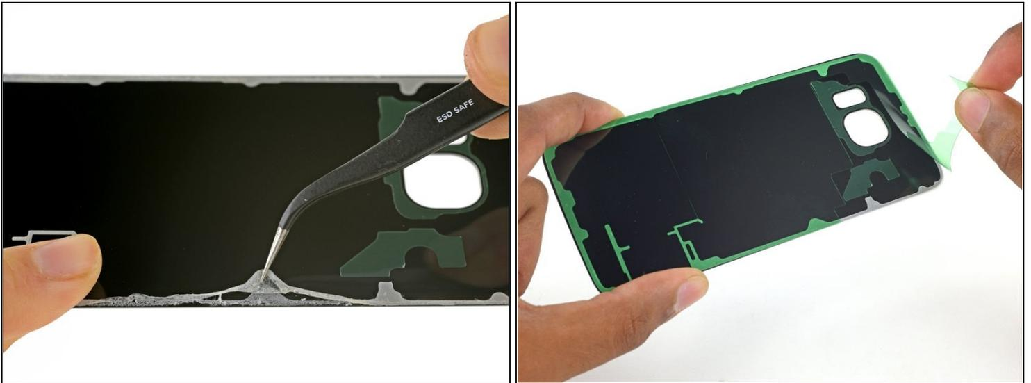
So wird das neue Rückseitenglas eingebaut:
