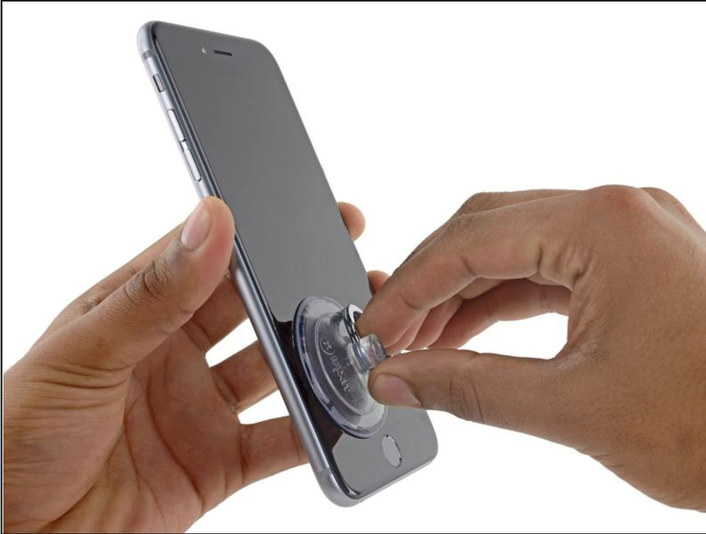
ⓘ Beim Öffnen des Displays vom 6s Plus bleibt um den Rahmen des Displays ein dünner Klebestreifen. Wenn du den Kleber ersetzen möchtest solltest du einen Satz neuer Klebestreifen bereithalten, bevor du weitermachst. Alternativ ist es möglich, die Reparatur zu beenden, ohne den Kleber zu ersetzen – du wirst wahrscheinlich keinen Unterschied merken.
