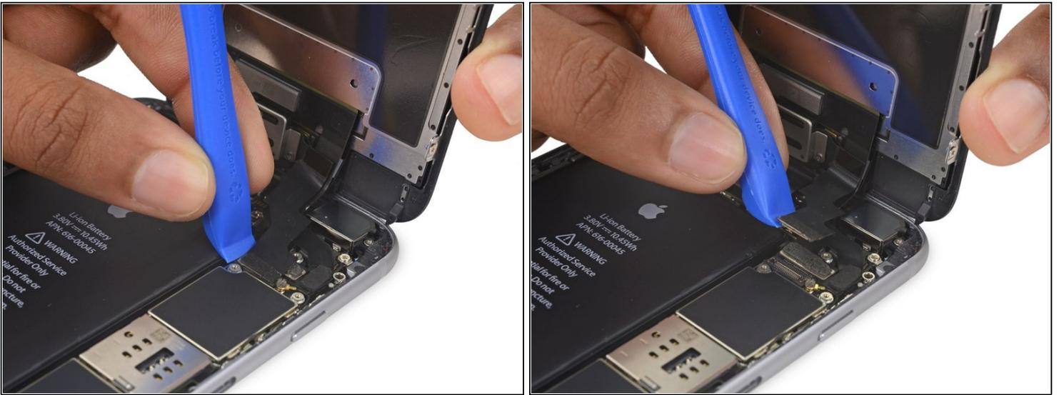
⚠ Achte darauf, dass du nur den Stecker selbst und nicht die Buchse auf dem Logic Board abhebelst.
