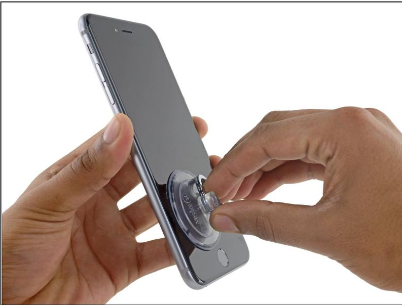
ⓘ Beim Öffnen des Displays vom 6s Plus bleibt um den Rahmen des Displays ein dünner Klebestreifen. Wenn du den Kleber ersetzen möchtest solltest du einen Satz neuer Klebestreifen bereithalten, bevor du weitermachst. Alternativ ist es möglich, die Reparatur zu beenden, ohne den Kleber zu ersetzen – du wirst wahrscheinlich keinen Unterschied merken.
