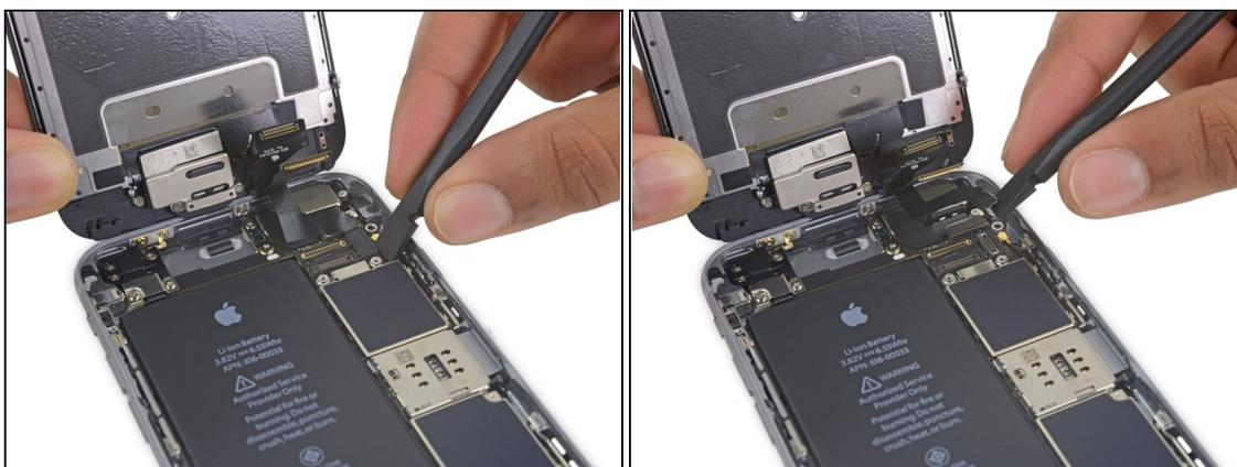
⚠ Der Akku muss abgetrennt sein, bevor du das Kabel in diesem Schritt ablöst oder wieder verbindest
