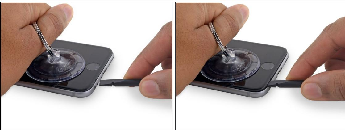
**i** An der Unterseite des Displays, direkt über der Kopfhörerbuchse, befindet sich eine Kerbe. Das ist die sicherste Stelle, um mit dem Aufhebeln des iPhones zu beginnen.
