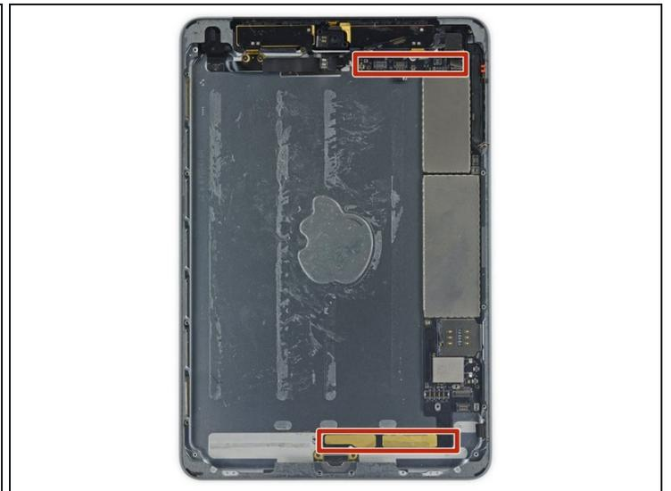
ⓘ Das Logic Board ist mit zwei Klebestreifen befestigt.
