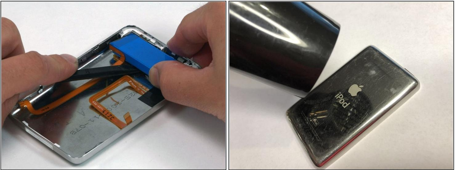
**⚠** Der Akku ist mit Kleber am hinteren Gehäuse befestigt. Achte darauf, die orangenen Flachbandkabel des Ohrhörer-Lautsprechers bzw. des Hold-Buttons nicht zu beschädigen, wenn du den Akku entfernst.
