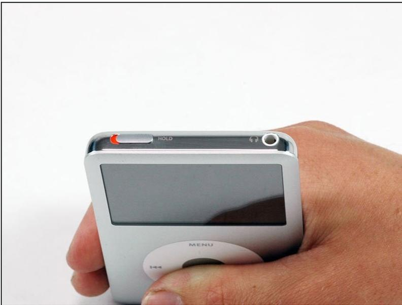
**⚠ Entlade zur Sicherheit den iPod komplett, bevor du das Gerät öffnest.** Dadurch verringert sich das Risiko eines Brandschadens, wenn der Akku während der Reparatur versehentlich angestochen wird. Wenn der Akku aufgebläht ist, musst du [geeignete Sicherheitsmaßnahmen treffen](#).
