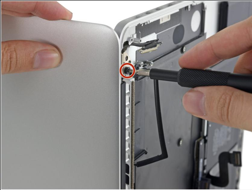
⚠ Halte das Display und das obere Gehäuse weiterhin mit der linken Hand zusammen. Andernfalls kann das frei bewegliche Display/obere Gehäuse hinfallen und möglicherweise jedes Bauteil beschädigt werden.
