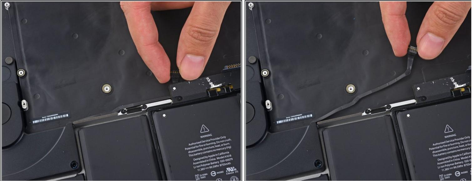
**i** Das rechte Lautsprecherkabel ist leicht am oberen Gehäuse angeklebt.
