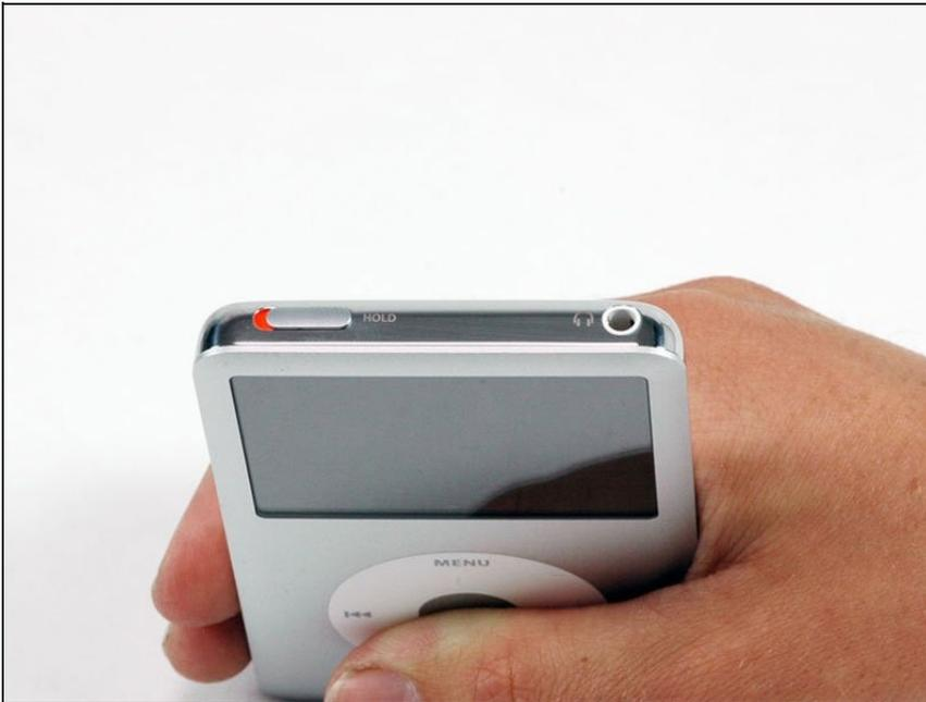
ⓘ Apple hat ihre neuen iPods so konzipiert, dass sie sich nur sehr schwer öffnen lassen, ohne wichtige Komponenten zu zerstören. Aufgrund der Metallfrontplatte, der Metallrückseite und der 13 (ja, 13) Metallklammern, die das Gehäuse zusammenhalten, ist dies einer der am schwierigsten zu zerlegenden iPods.
