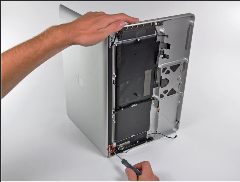
**⚠** Achte darauf, das Display mit dem Gehäuse weiterhin mit der Hand zusammenzuhalten. Wenn du das nicht tust, kann das Display/obere Gehäuseteil herunterfallen und unter Umständen kann jede Komponente beschädigt werden.
