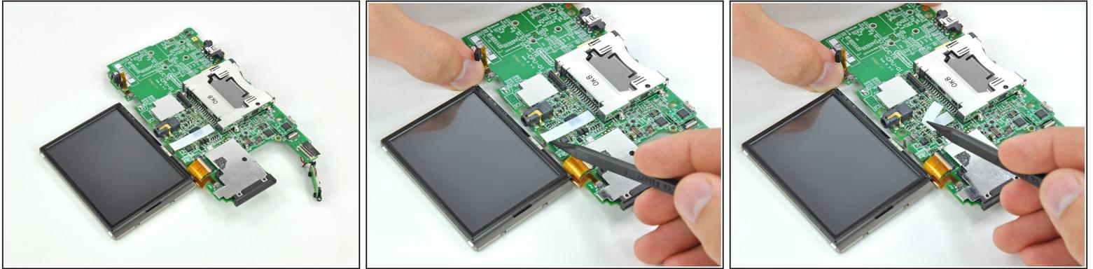
**i** Lege die Hauptplatten-Einheit so ab, dass das untere LCD Seite an Seite zur Hauptplatine liegt.
