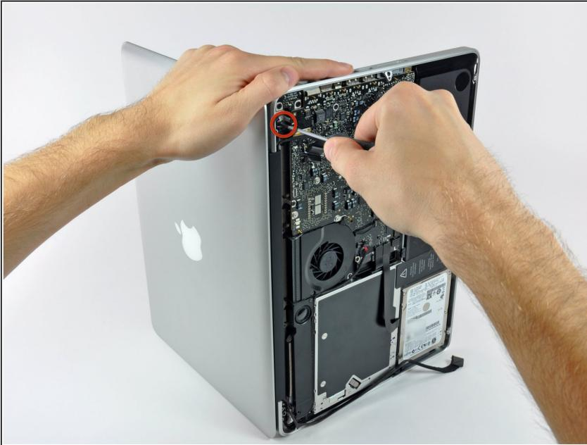
**⚠** Achte darauf, das Display und das Gehäuseoberteil gut mit der linken Hand festzuhalten. Wenn du dabei einen Fehler machst, könnte das Display/ Gehäuseoberteil hinfallen und dabei jedes Bauteil beschädigt werden.
