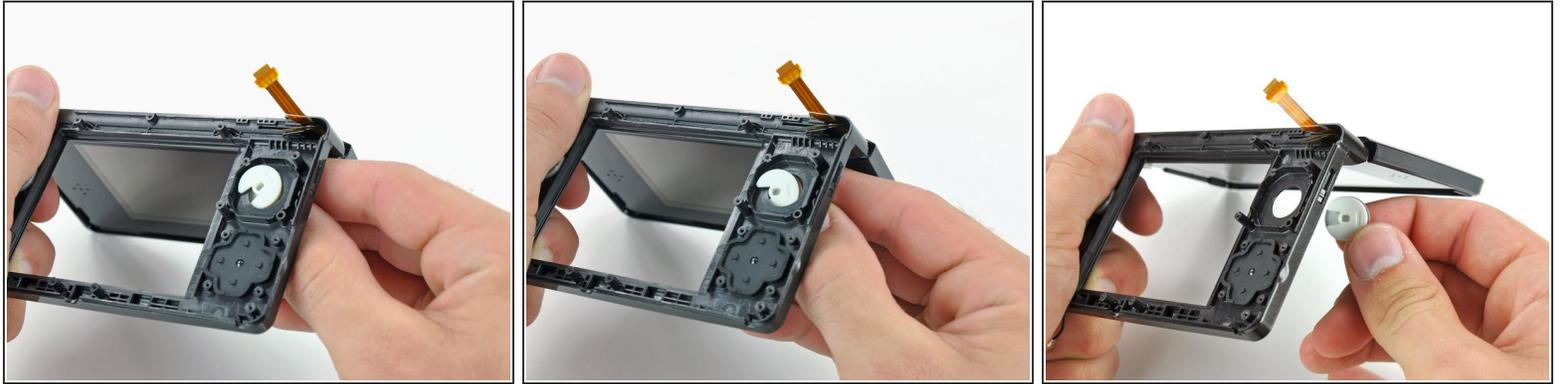
**i** Öffne den 3DS und halte ihn so, dass die Unterseite der Tasten nach oben zeigen.
