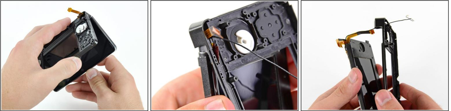
**⚠** Merke dir gut die Orientierung der drei Flachbandkabel, bevor du weitermachst (wohin die Goldkontakte zeigen), und in welcher Reihenfolge sie übereinander geschichtet sind. Die Kabel sind zu kurz, um Kontakt herzustellen, wenn sie in anderer Weise geführt werden.
