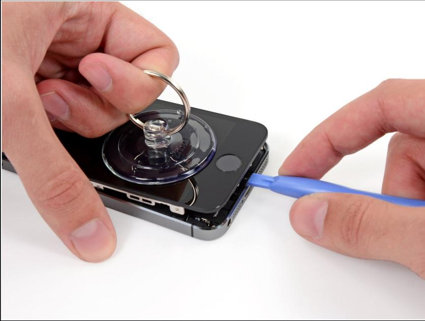
**!** Das Frontpanel ist mit Clips festgemacht und es gibt mehrere Flachbandkabel, die es mit dem übrigen Telefon verbinden. Dein Ziel hier ist, die Clips zu lösen und **das Telefon gerade so weit zu öffnen, um die Kabel lösen zu können**. Gehe langsam und behutsam vor, um Schäden zu vermeiden.
