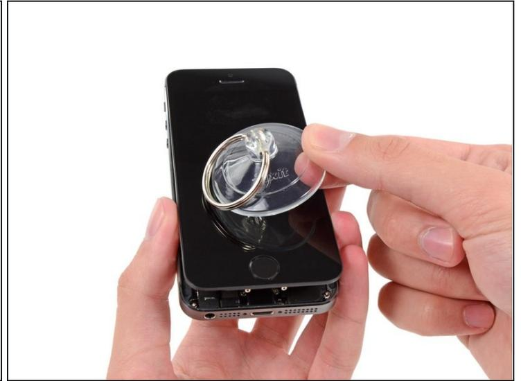
**⚠ Versuche nicht, die Display Einheit vollständig vom hinteren Gehäuse zu lösen, da beide immer noch durch mehrere Flachbandkabel verbunden sind.**
