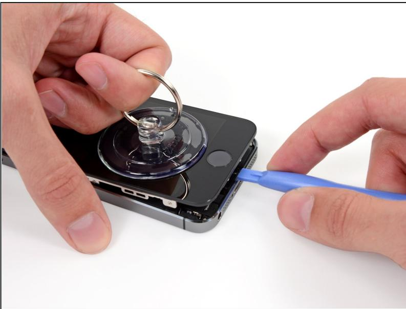
⚠ Das Frontpanel ist mit Clips festgemacht und es gibt mehrere Flachbandkabel, die es mit dem übrigen Telefon verbinden. Dein Ziel hier ist, die Clips zu lösen und **das Telefon gerade so weit zu öffnen, um die Kabel lösen zu können**. Gehe langsam und behutsam vor, um Schäden zu vermeiden.
